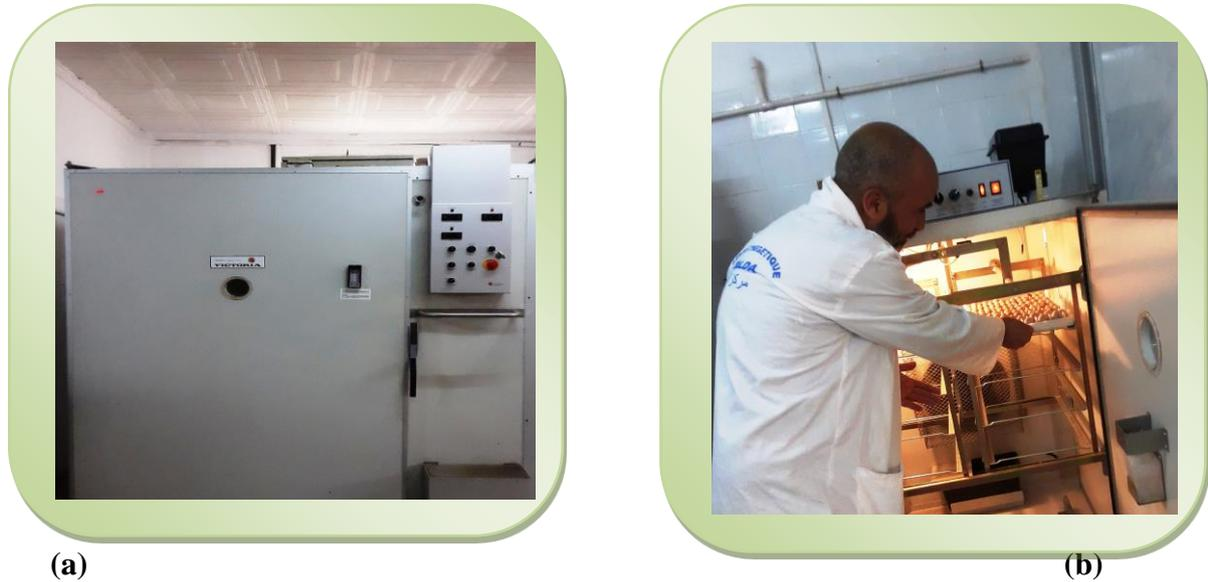
**Figure 44** :(a)Appareil d'incubation VICTORIA I-72 (b) Mise en place des œufs en incubation (original 2021)
