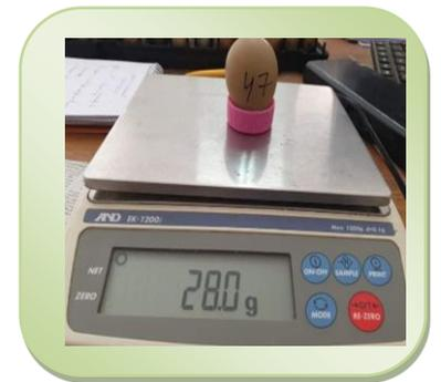
**Figure 42** : Pesées et mesures des dimensions des œufs (originale 2021)
