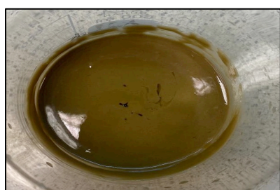
Figure 6-23 : Résultat du test de compatibilité entre la boue de forage et l'acide OPR LT à 64°C (à gauche) entre la boue et l'acide HCl 15% 64°C (à droite)
