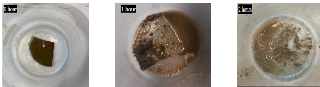
Figure 6-24 : Test de solubilité du Mud Cack avec NaqiCLEAN
