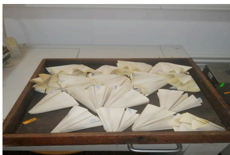
Figure 6-25 : Cuttings mise au séchage
