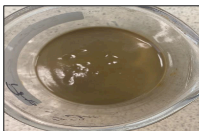
Figure 6-23 : Résultat du test de compatibilité entre la boue de forage et l'acide OPR LT à 64°C (à gauche) entre la boue et l'acide HCl 15% 64°C (à droite)
