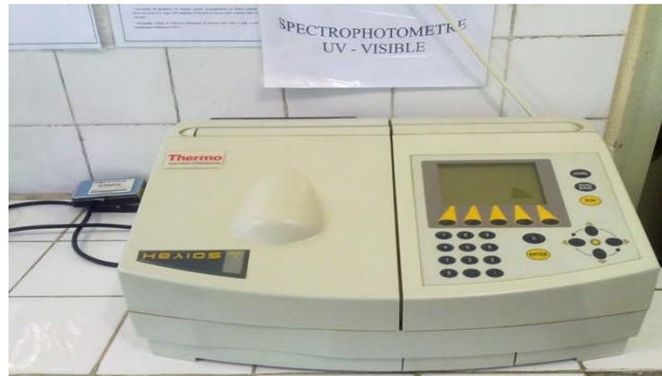
**Figure 1:** Spectrophotomètre UV-Visible
