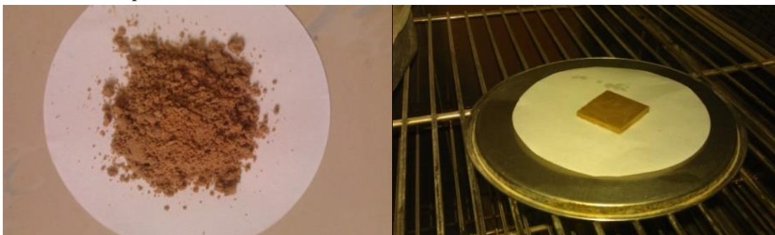
figure 2. 11 : Test de fuite de MCP.
