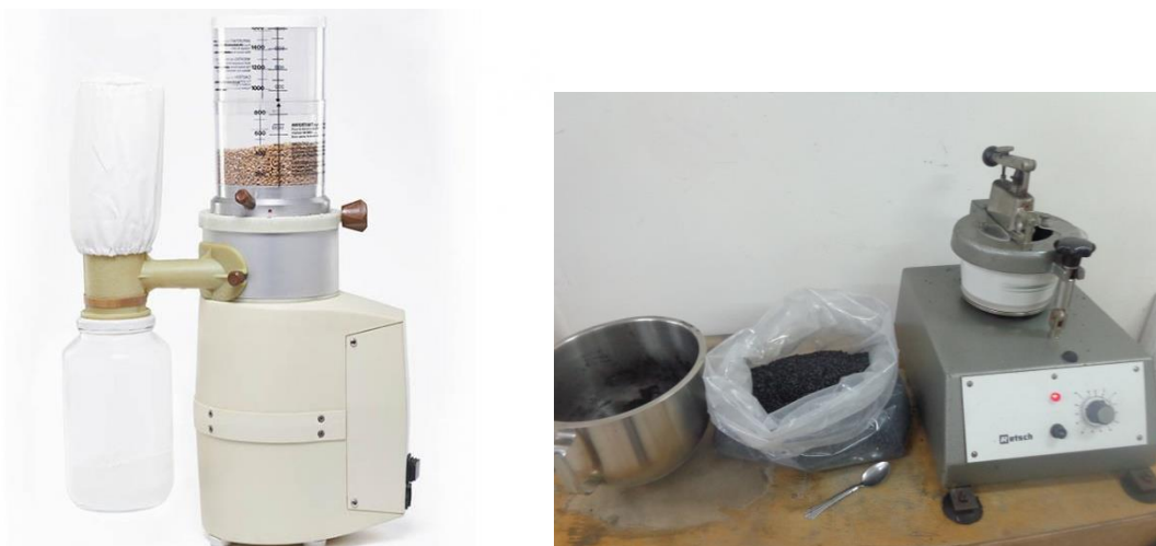
figure 2.1 : Broyeurs utilisés dans les étapes de broyage des différentes poudres. A gauche) Broyeur SAMPA, à droite) Broyeur RETSCH
