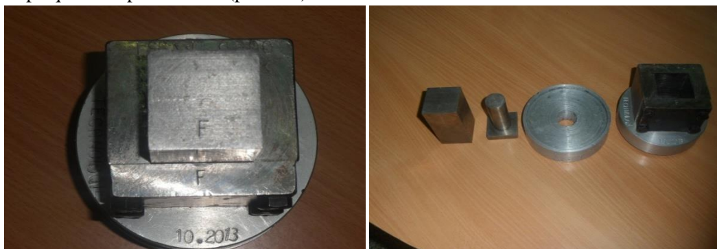
figure 2.13 : Moule utilisé pour la réalisation des pastilles
