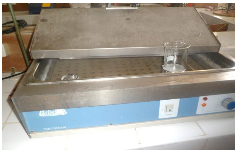
figure 2. 12 : Bain marie thermostaté utilisé dans la préparation des composites MCPs.
