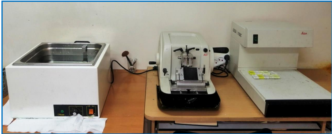
Figure 50. Dispositif permettant la réalisation des coupes histologiques. De droite à gauche : la plaque refroidissante, le microtome et le bain-marie (Originale, 2023)
