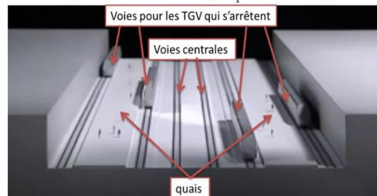
Figure II-84 : Vue sur les quais et les voies ferrées.
