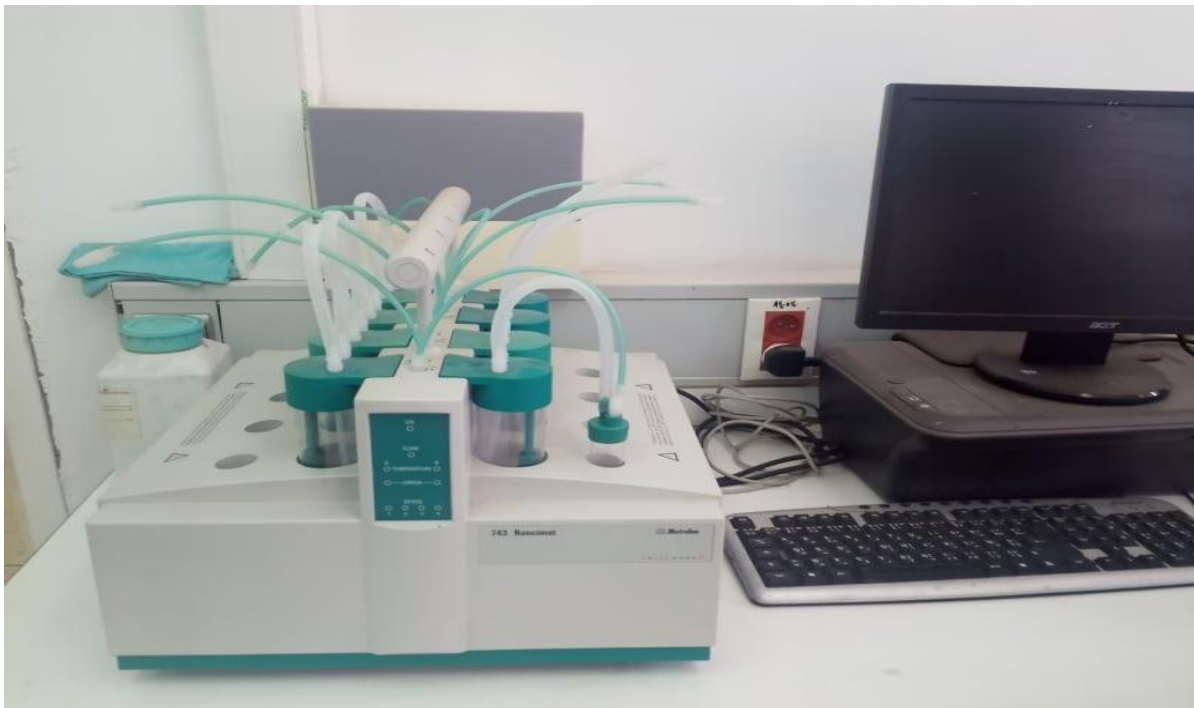
Figure 19 : Appareil «743 Rancimat Metrohm».
