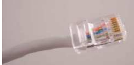
RJ45 : câble réseau 8 fils.
