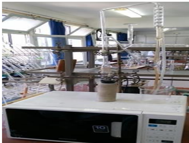
Figure 1 : Dispositif d'hydrodistillation assistée par chauffage micro-onde
