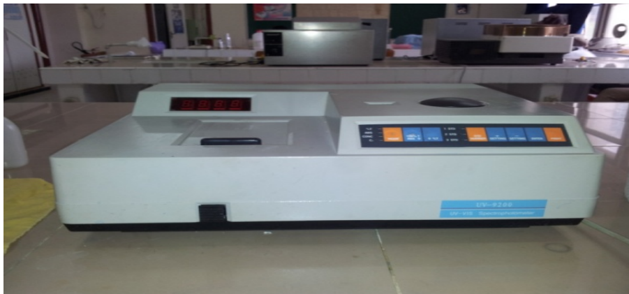
Figure 10 : Spectrophotomètre UV visible (photo originale).
