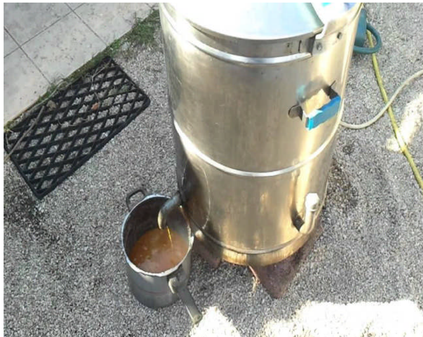
Figure07 : Ecoulement de la cire fondue de la chaudière à vapeur ( Schryve, 2016 ).
