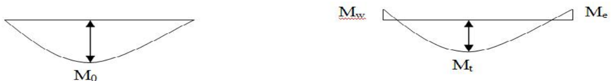
Figure 12 : Diagramme des moments (principe de la méthode forfaitaire)
