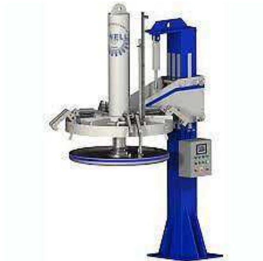
Fig 16 : Presse à table mobile et bigorne. [6]
