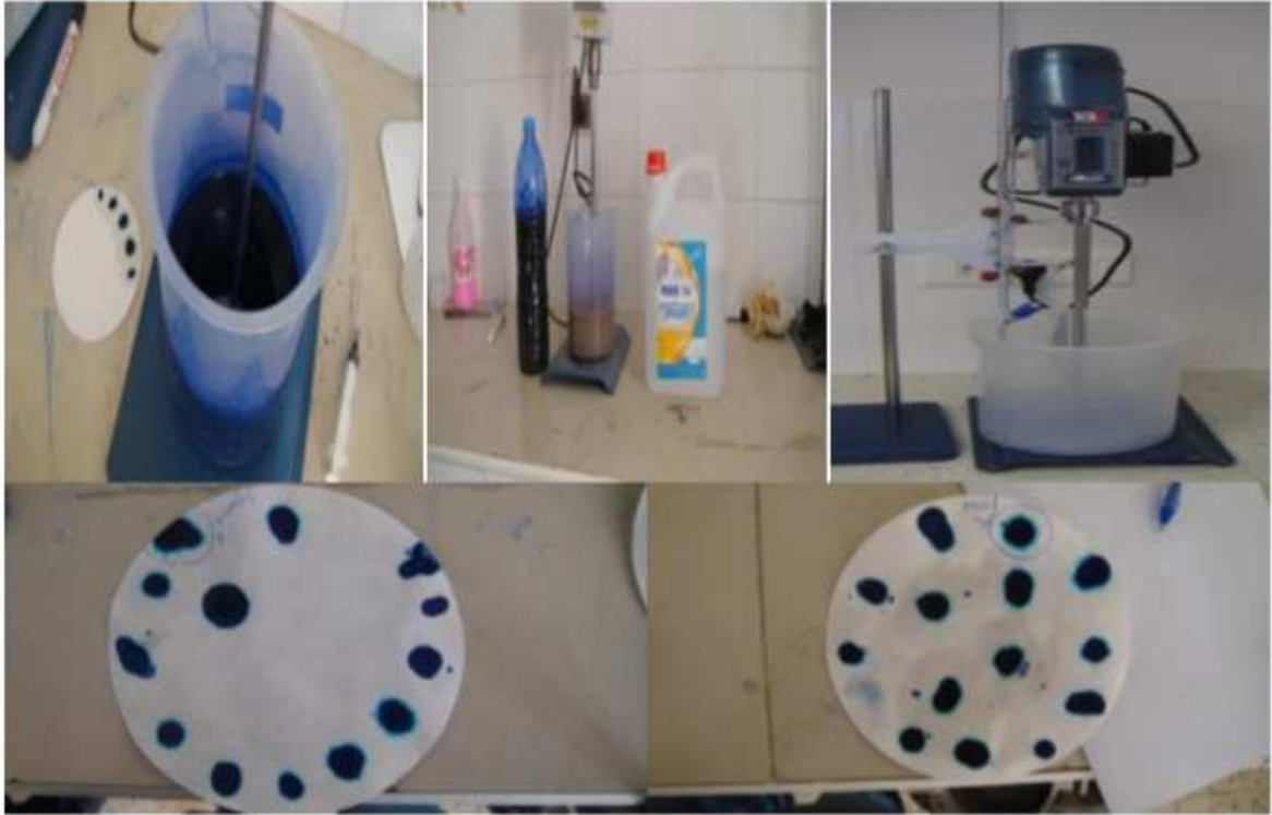
Figure IV.21. Matériel d'essai au bleu de méthylène (résultats de l'essai à la tâche).
