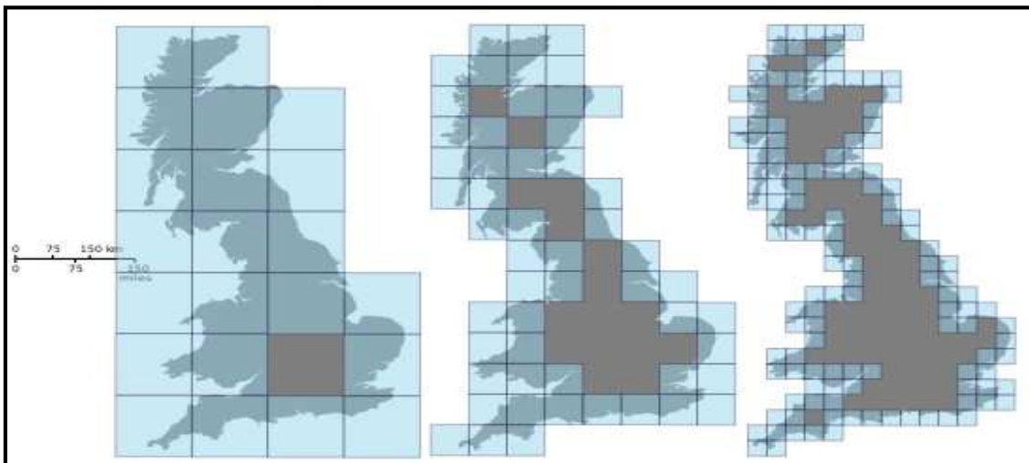
Figure. I.17. Recouvrement de la côte de Grande-Bretagne par des réseaux carrés de maille décroissante.
