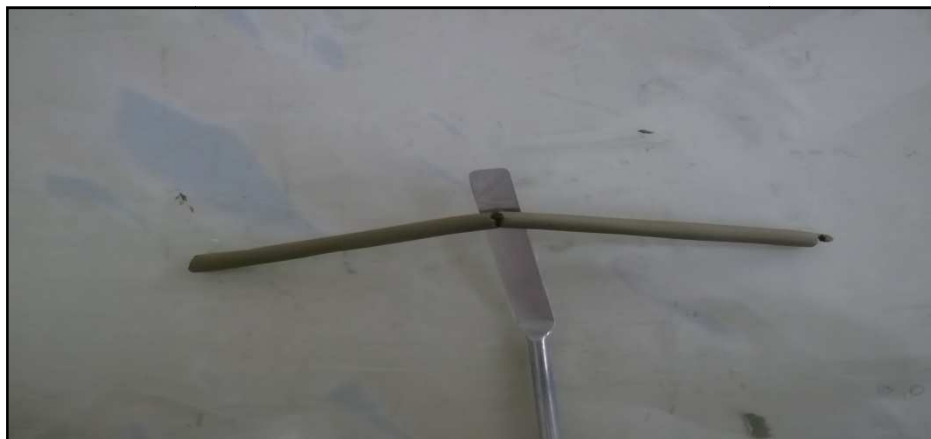
Figure IV.15. Cassure du Cylindre
