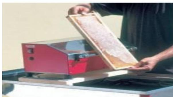
**Figure08:**Désoperculation des alvéoles avec la machine Caillas
