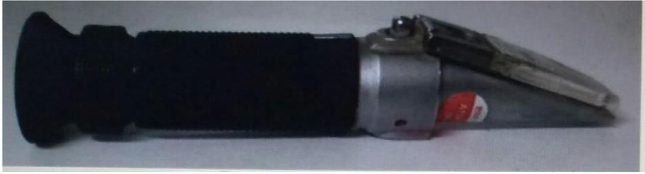
**Figure 20:** Réfractomètre (Prost et le conte, 2005).
