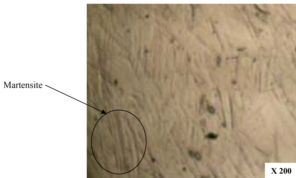
Figure II.36. Microstructure de l'acier 304L avec un grossissement X200, pour une déformation de 67%
