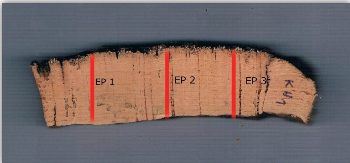
Figure 34 : Prélèvement des éprouvettes de liège pour mesurer l'épaisseur des cernes. Source : originelle
