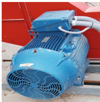
Figure II.8. Le moteur triphasé asynchrone à cage d'écureuil WEG B3 de 110 KW
