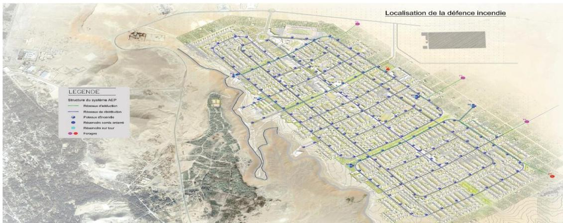
Figure 3.13 : Schéma de principe de la défense incendie.
