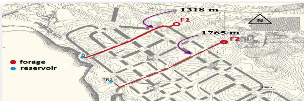
Figure 3.4 : Tracé des conduites d'adduction.
