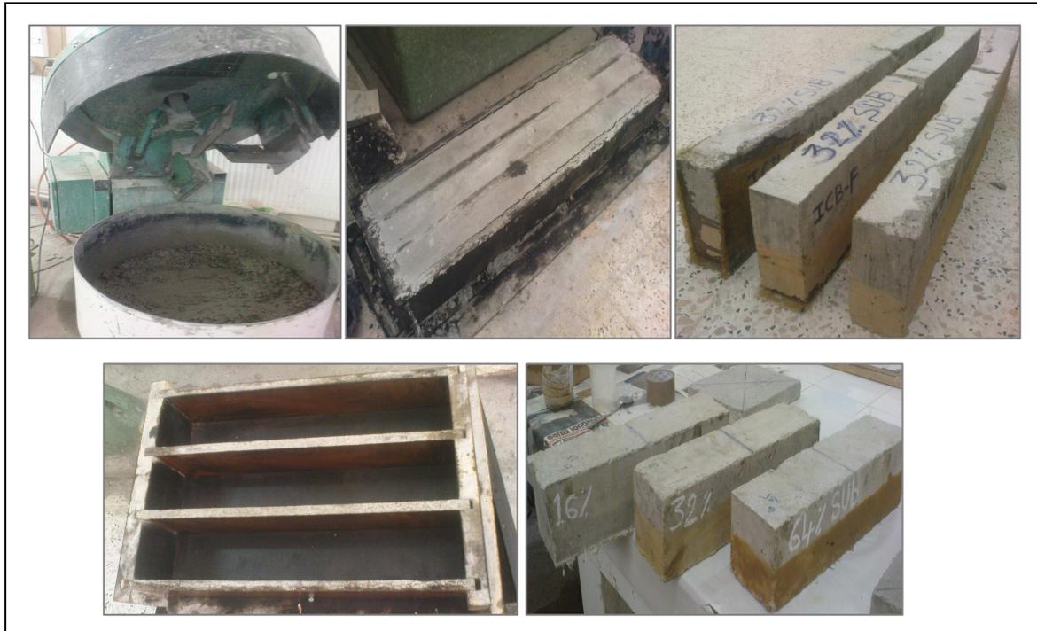
*Figure II.14. Confection des éléments poutres et prismatiques*
