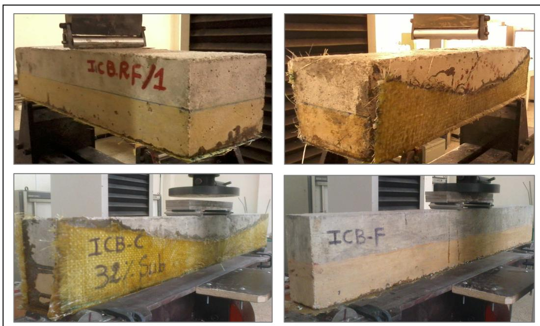
*Figure II.16. Mode de chargement des différents spécimens.*
