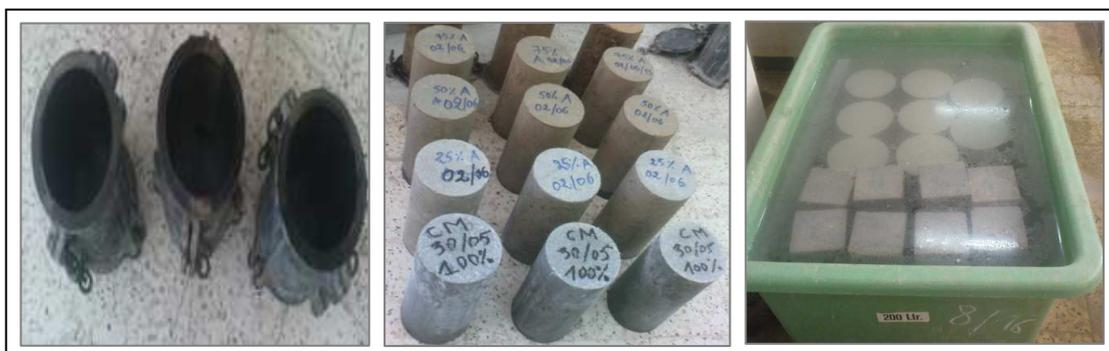
**Figure II.2.** Préparations des éprouvettes cylindriques en béton ordinaire.
