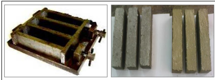
**Figure II.5.** Moule et éprouvettes d'essai de traction par flexion pour le béton ordinaire
