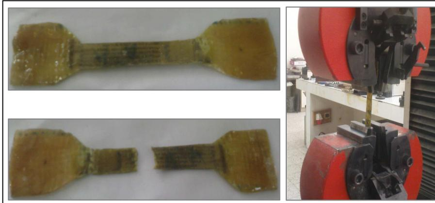
*Figure II.11. Eprouvettes confectionnées selon la norme pour un essai de traction*
