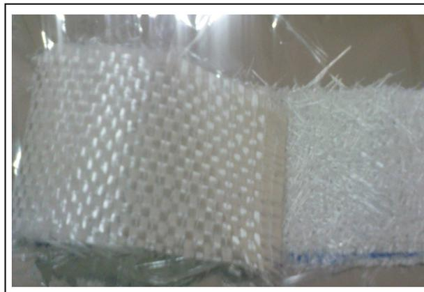
*Figure II.9. Tissu GFRP utilisé pour le confinement des poutres non homogènes.*
