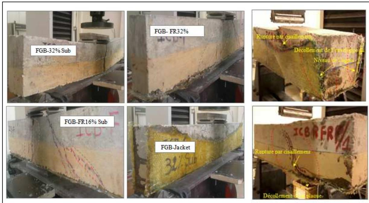
*Figure II.20. Comparaison morphologique des modes de rupture des spécimens.*
