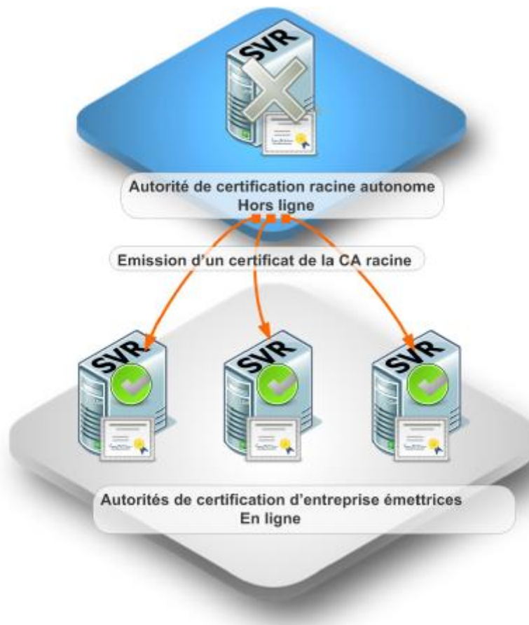
Figure III.6. Infrastructures d'une CA à deux couches.
