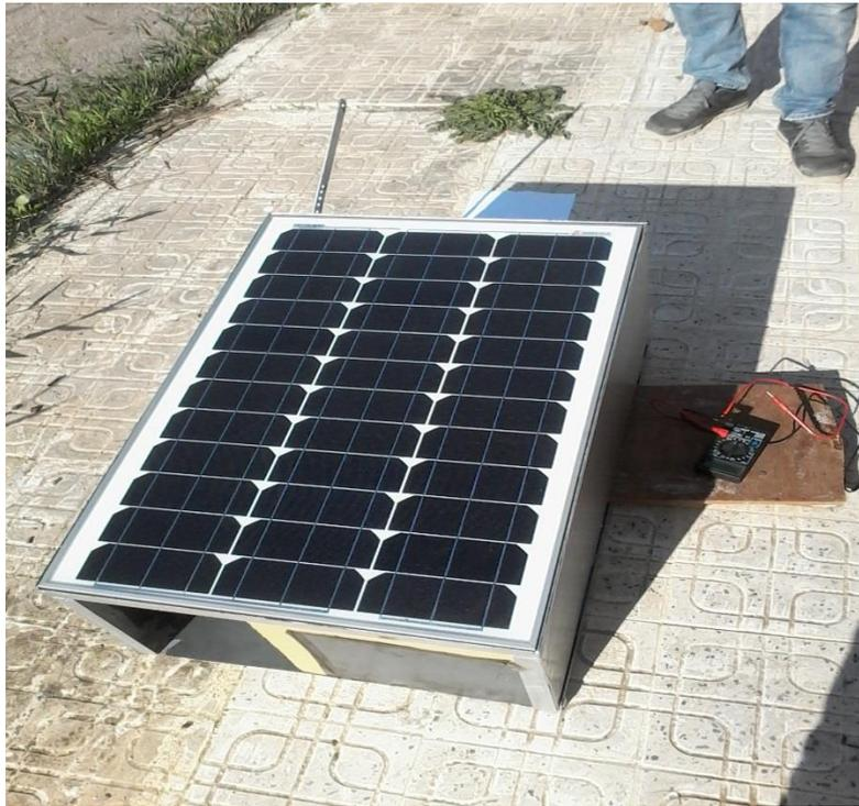
Figure III.11 : variation de l'angle d'inclinaison du panneau
