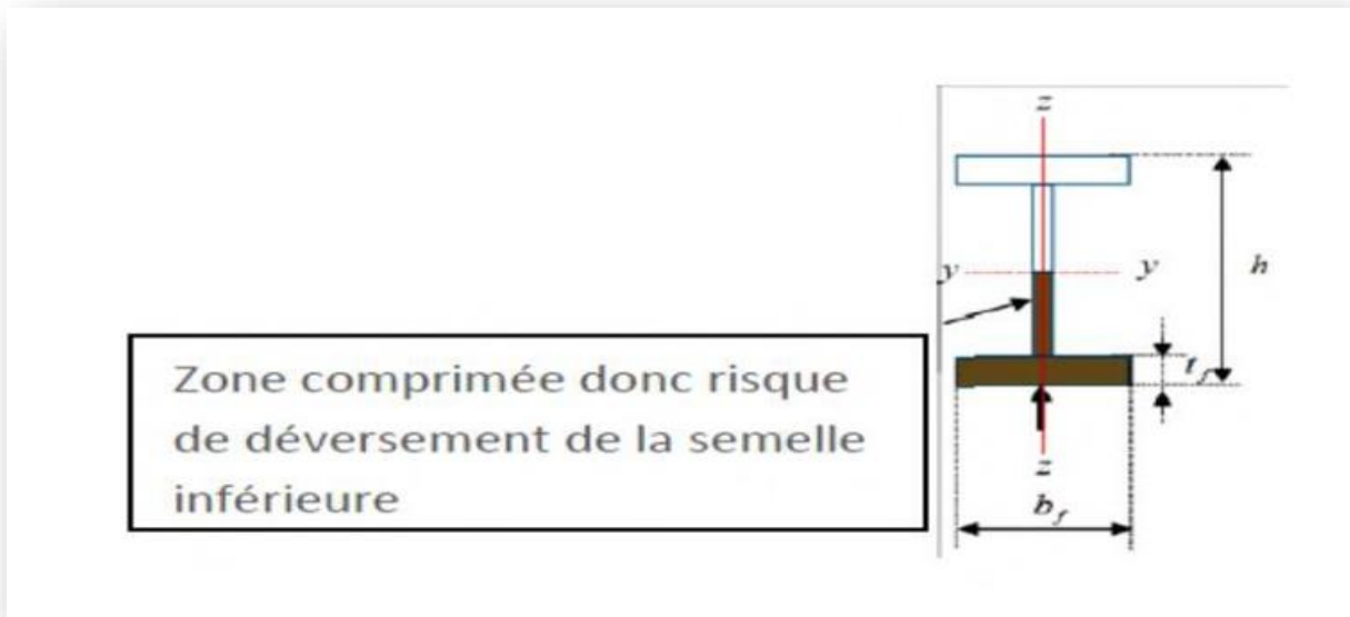
Figure III.06 : Panne de toiture en déversement.
