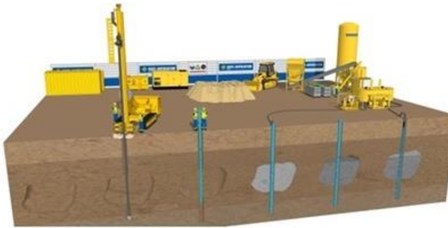
Figure IV.8 : injection du sol [36]
