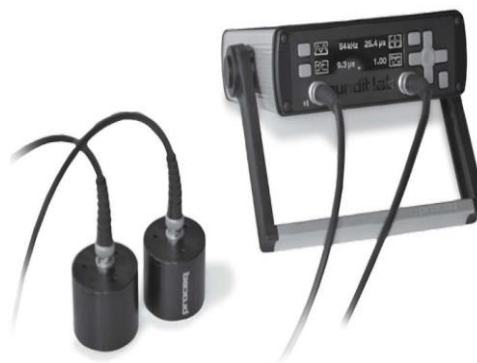
b) Appareil à deux transducteurs [8]
