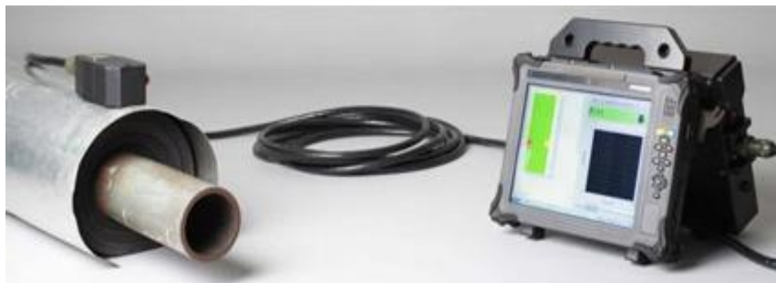
Figure III.6 : Appareils et sondes utilisés dans un CND par courants de Foucault [27]
