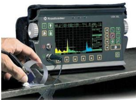
a) Appareil à un seul transducteur [26]
