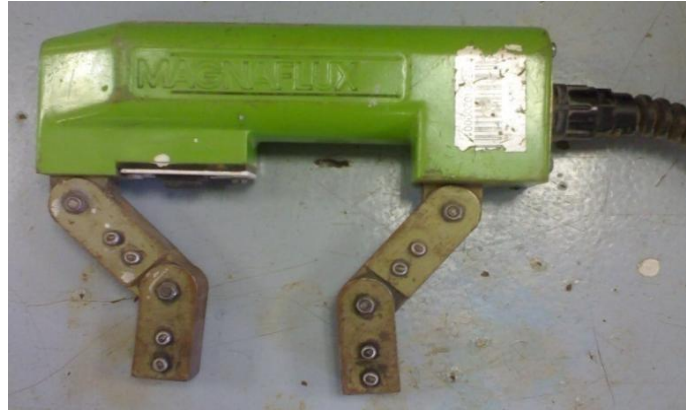
Figure III.9 : Appareil de contrôle par magnétoscopie. [27].
