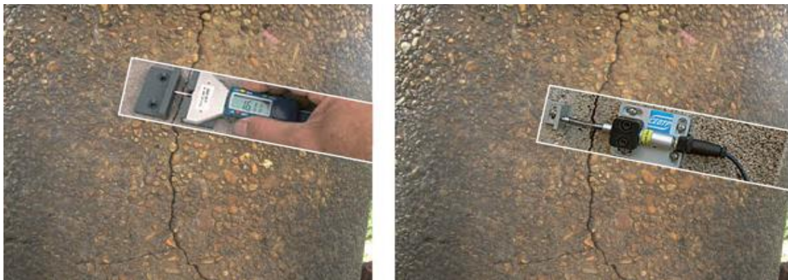
Figure III.13 : Exemple d'utilisation du capteur de déplacement potentiométrique [23]
