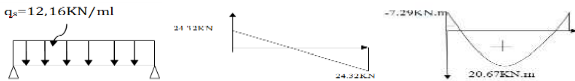
Figure III.5.2 : Diagramme des efforts tranchants et des moments fléchissant à l'ELS
