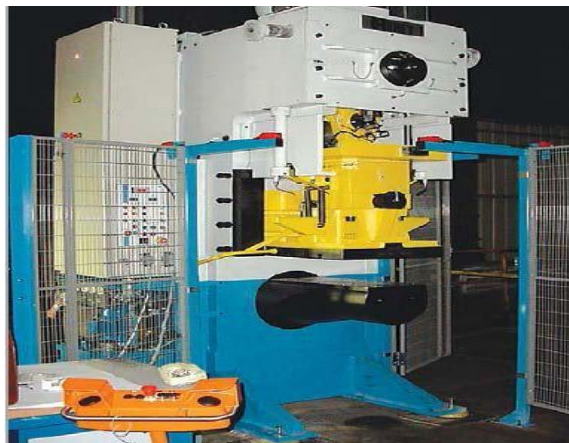
Figure III.7: Presse à table mobile et bigorne
