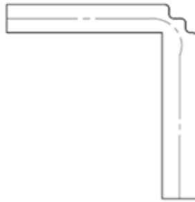
Figure II.35 : Déformations à un angle vif ( R=0 ).
