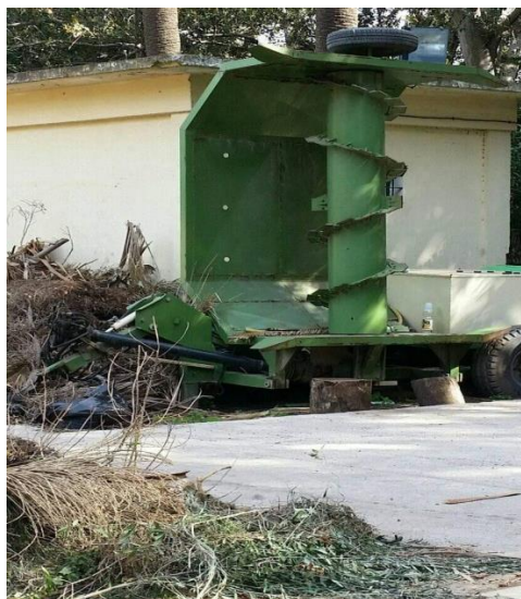
Annexe 13: Broyeur destiné au broyage des palmes sèches (Original, 2020).
