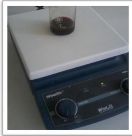
**Figure (15) :** Agitation magnétique du mélange.
