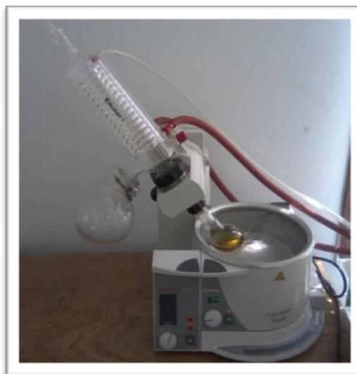
**Figure(9) : L'évaporateur rotatif**
