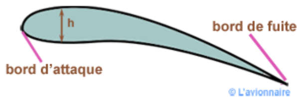
Figure 44 _ l'épaisseur de l'aile [8]
