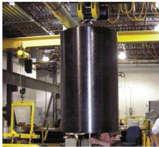
Figure I.14 : Stockage d'énergie par volant d'inertie
