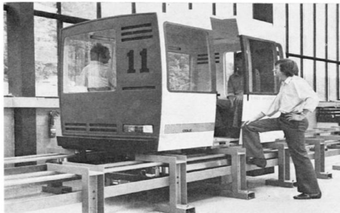
Figure I.1 Véhicule à suspension électromagnétique, réalisé à l'université de Sussex
