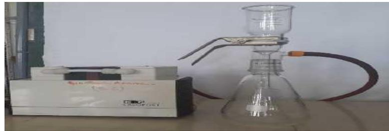
**Figure 27 :** Appareil de filtration sur membrane « Sartorius ».
