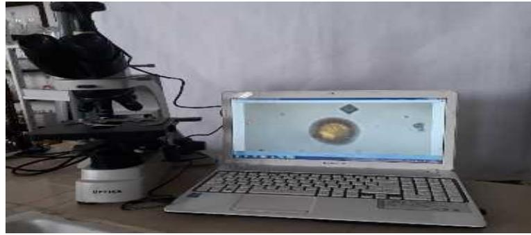
**Figure 26 :** Microscope photonique connecté à l'ordinateur et l'outil de la caméra.
