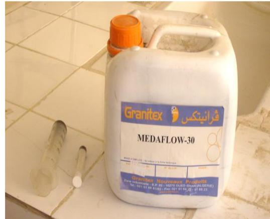
**Figure II.18 :** Plastifiant MEDAFLOW-30 utilisé
