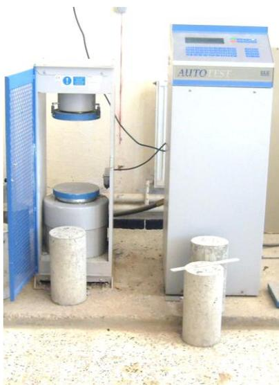
**Figure II.21.a :** Presse à essai d'écrasement
