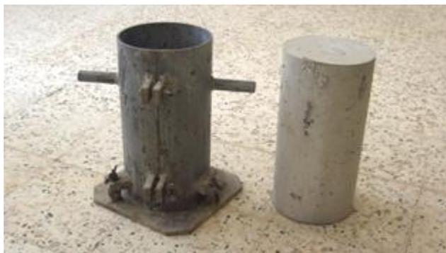
**Figure II.20:** Coffrage métallique de l'éprouvette de compression
