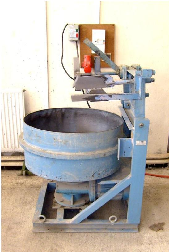
**Figure II.17:** Le malaxeur de béton du laboratoire
