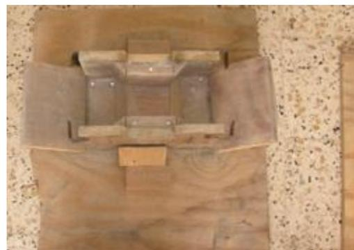
**Figure II.28. a:** Coffrage d'éprouvettes de traction
