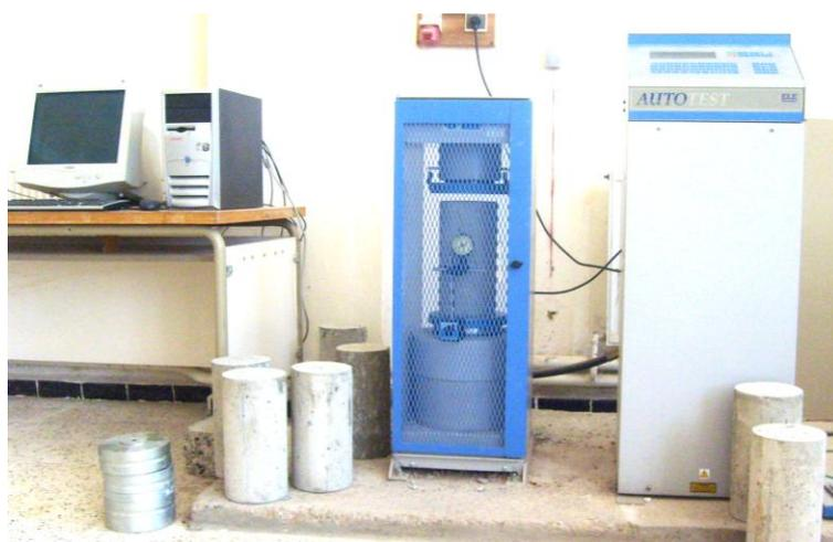
**Figure II.21.b:** Essai de compression avec logiciel de commande
