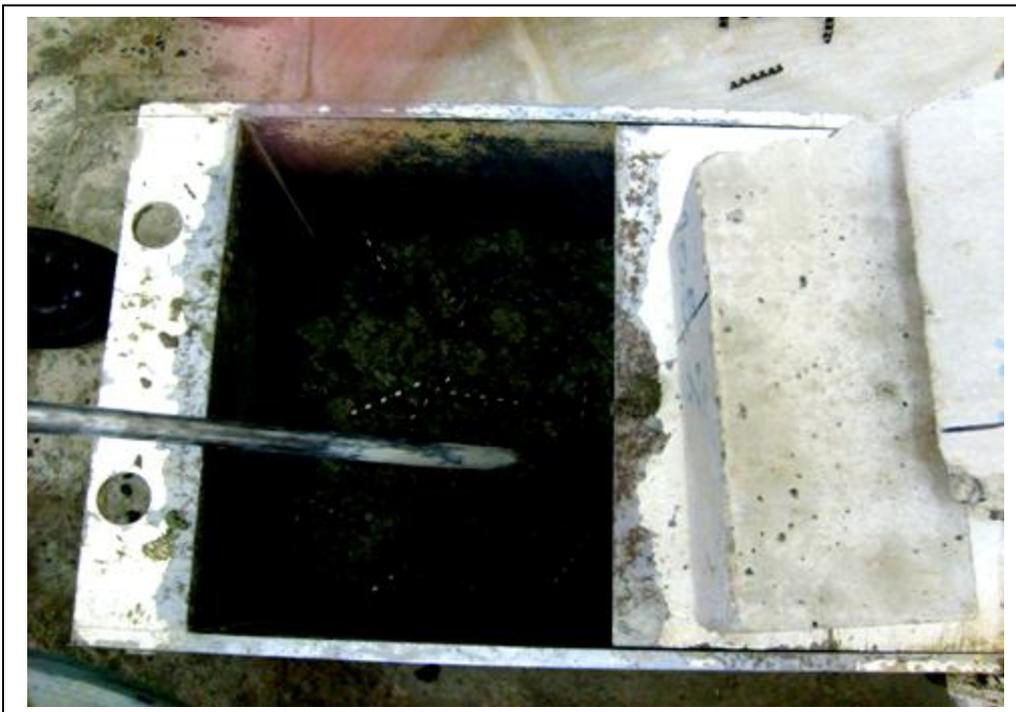
**Figure II.8:** Remplissage du béton de fibres dans le maniabilimètre.
