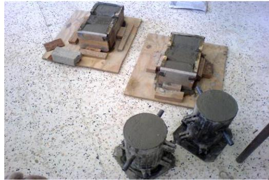
**Figure II.29:** Préparation d'éprouvettes pour l'essai de traction
