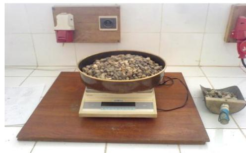
**Figure II.16:** Pesage des granulats
