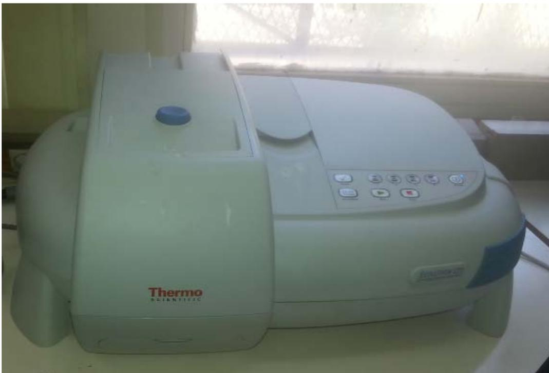
**Spectrophotomètre UV-VIS [thermo scientific]**
