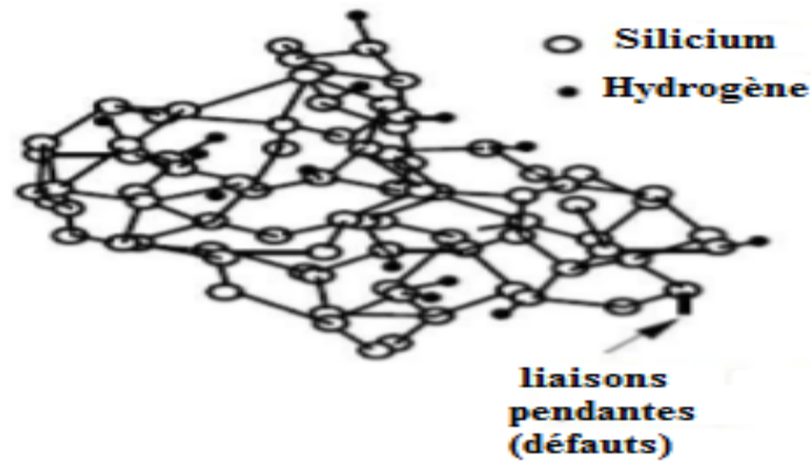
Figure I.4: La structure du silicium amorphe hydrogéné [13].
