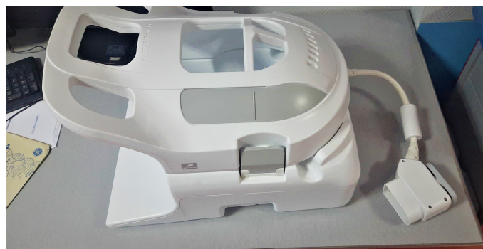
FIGURE 3.7 – Antenne tête à 8 éléments de réception
