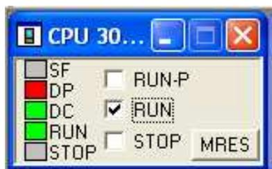
**Figure IV.18** : mise en marche de la CPU.
