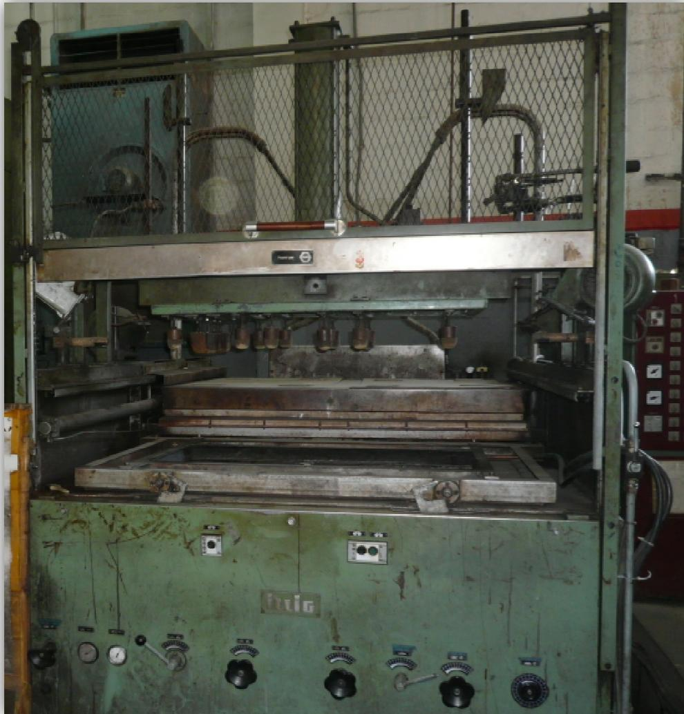
***Figure I.2 :*** photographie de la machine ILLIG.
