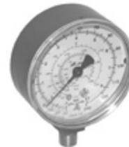
**Figure I.16** : vacuomètre et sa symbolisation.
