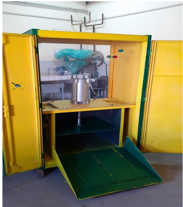
Figure III-30 : La presse à balle après la peinture
