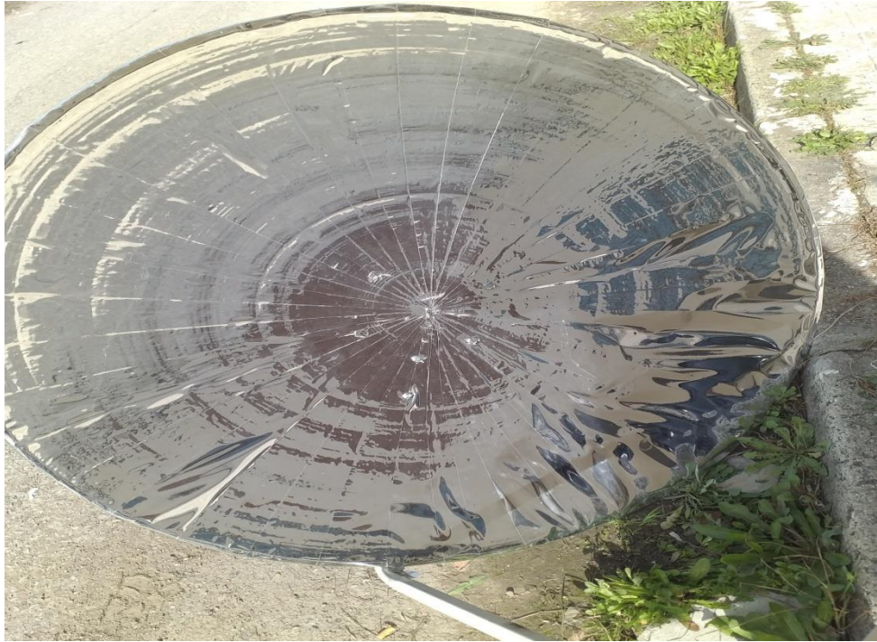
Figure IV-8: Collage de l'Aluminium sur la parabole
