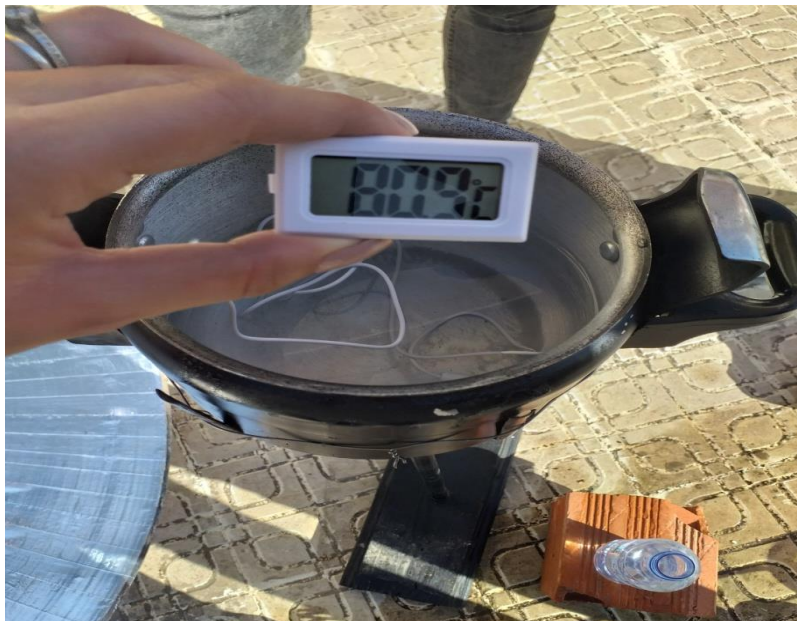
Figure V-4: Mesure de la température à l'ouverture du récepteur
