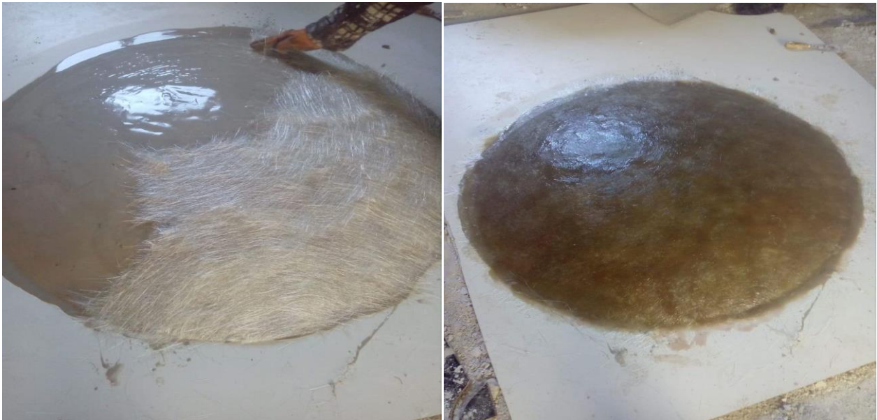
Figure IV-6: Moulage de la parabole
