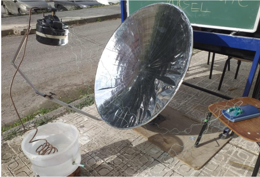
Figure V-3 : Emplacement du thermocouple sur le concentrateur
