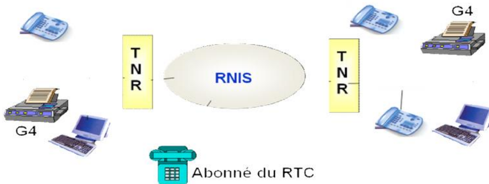
Figure I.4 : Exemple d'un réseau RNIS.
