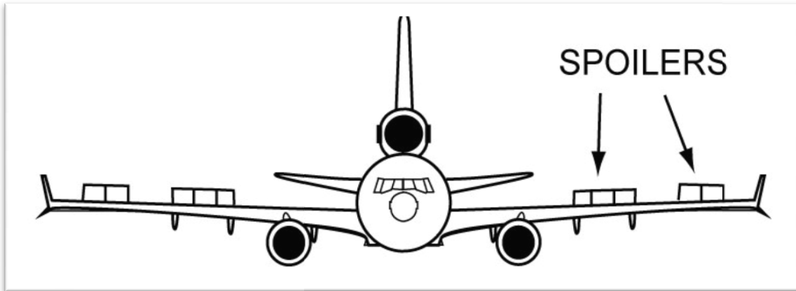
Figure 3. 9 : La fonction aérofreins
