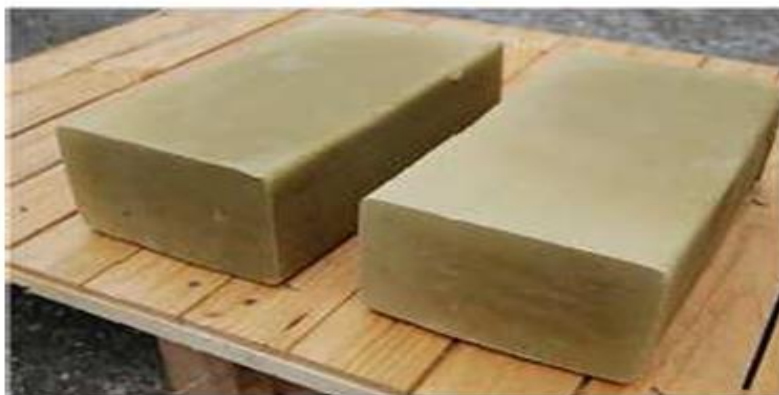
Figure 5 : Briques non cuites obtenues à partir des margines (Amrani et Bendidi, 2014)
