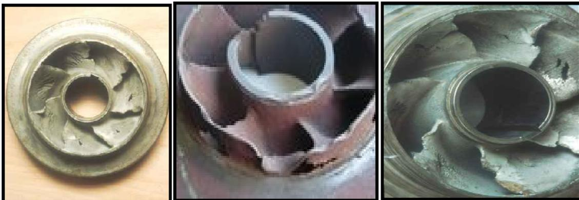
**Figure 8.9: Photos illustrant le phénomène de cavitation sur les aubes d'une pompe centrifuge**
