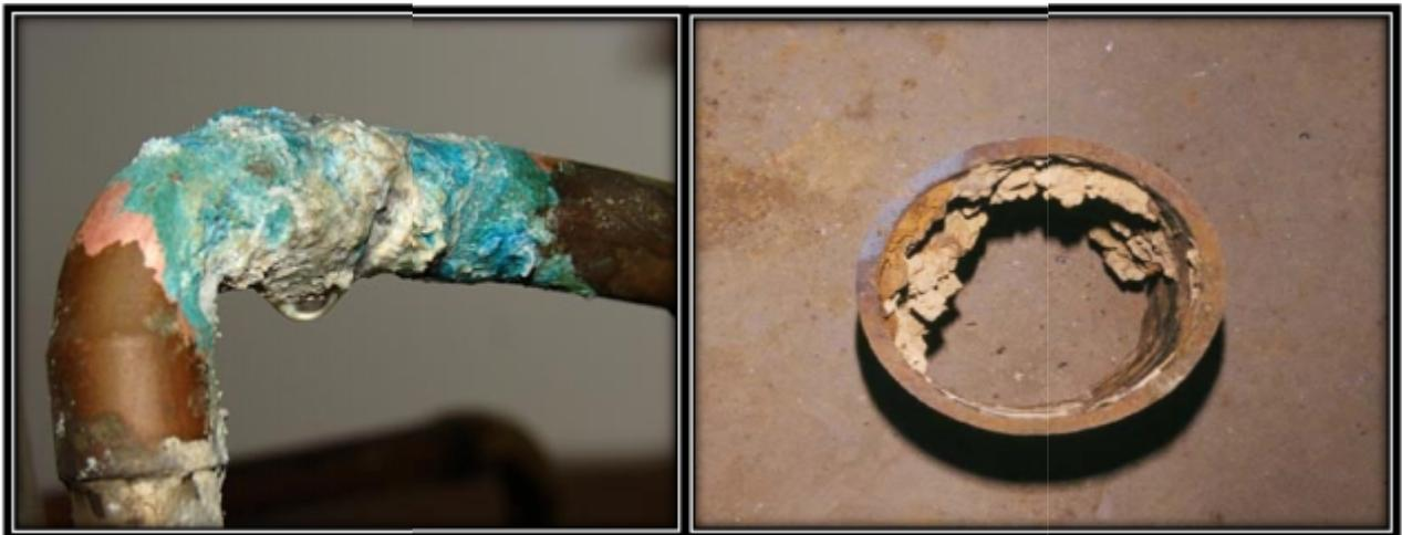
Figure 5.11: La corrosion des conduites
