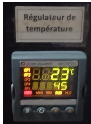
Figure III.18 : Le régulateur de température utilisé, en cours de fonctionnement : 23°C indique la température instantanée, 45°C indique la consigne instantanée et OP1 et OP2 indiquent que le chauffage est enclenché
