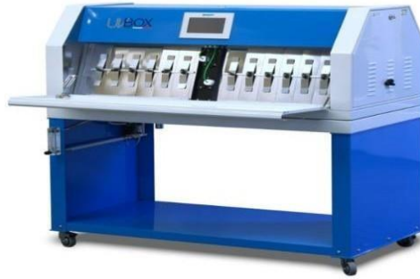
Figure II.2 : Dispositif de vieillissement rapide, tests de vieillissement accéléré, test de vieillissement aux UV (rayonnement UV), condensation de l'humidité.
