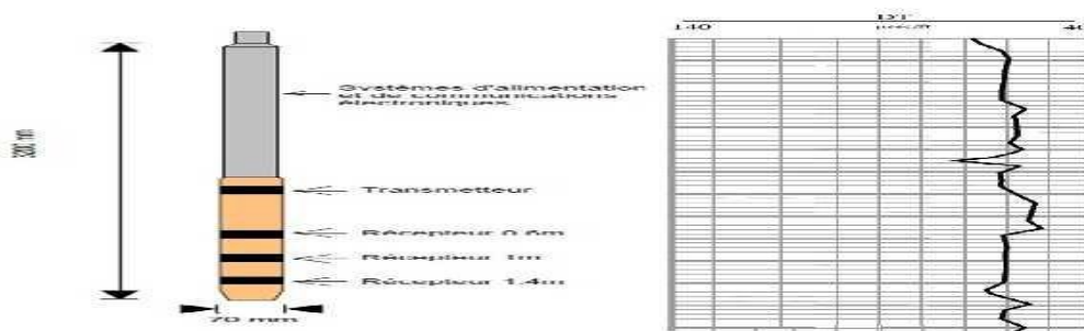
Figure IV.4 : Schéma de principe d'une sonde FWS (Full-Wave-Sonic) et exemple de log sonique
