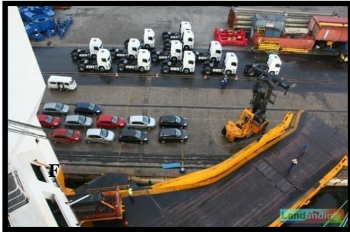
Figure 70 passerelle pour véhicules source :
