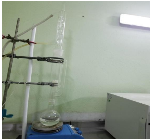
Figure 11 : Dosage de lipide (SOHXLET)
