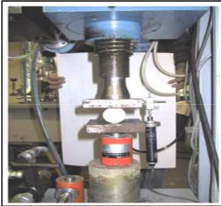
Figure : III.12 : Essai Brésilien sur Presse Mécanique (ULG)
