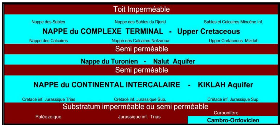
Figure I.7 : Schéma Hydrogéologique Simplifié du SASS (OSS, 2003)
