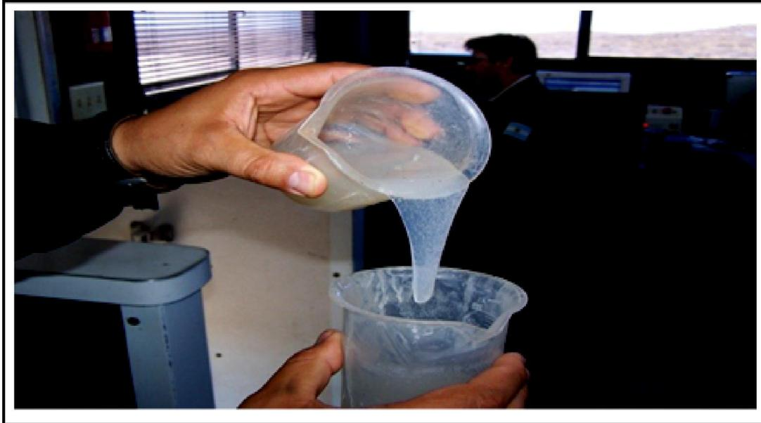
**Fluide IV.7: Fluide de la Fracturation (J-J.BITEAU)**
