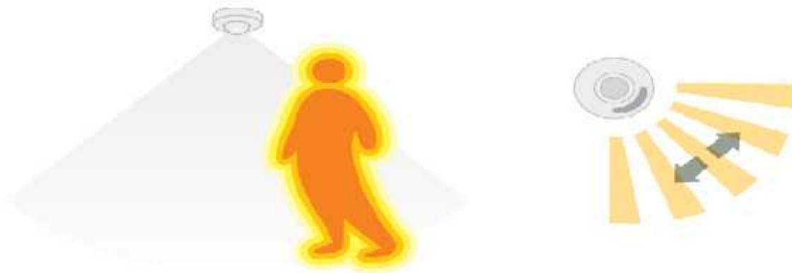
Figure 15 : détection de présence par infrarouge [NIK Web]
