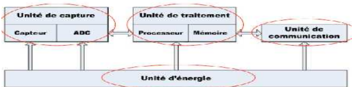
Figure2: Architecture d'un capteur. [AAC 2014]
