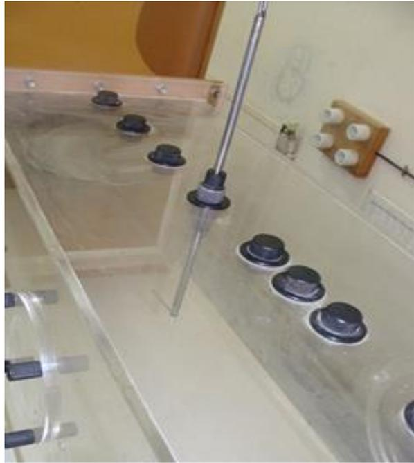
**Figure III.7: Image d'un tube Pitot**
