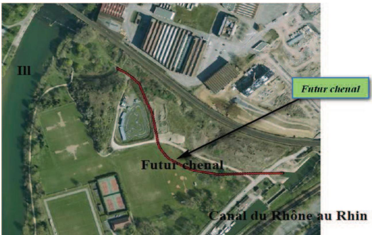
Figure I.6 : Tracé du nouveau chenal vers le canal du Rhône au Rhin.
